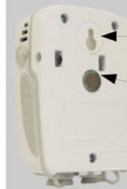
Установка на стене и скважина для ключа
